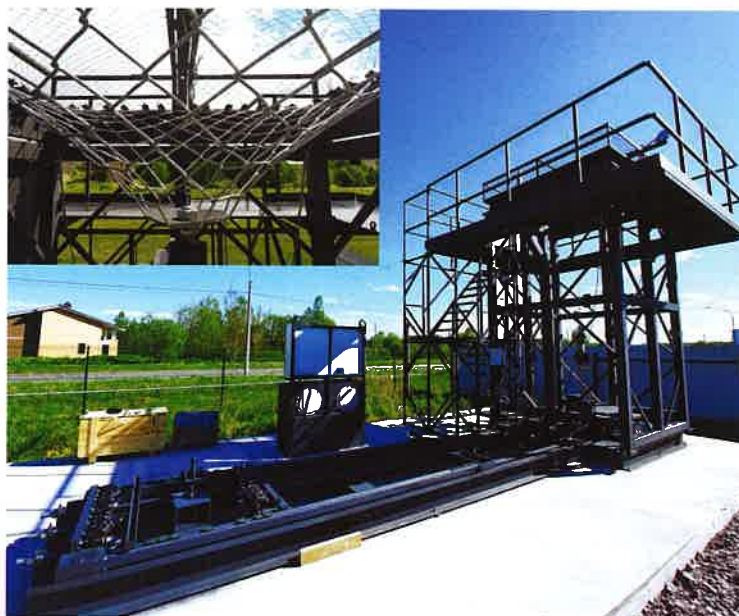
Рис. 6. Общий вид испытательного стенда ООО «ТР Инжиниринг» и выполнение на нем испытаний сетки на продавливание (фрагмент в верхнем углу)
