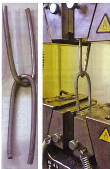
Рис. 4. Образец, подготовленный для испытаний узлов сплетения сетки на растяжение, и его испытание на разрывной машине
